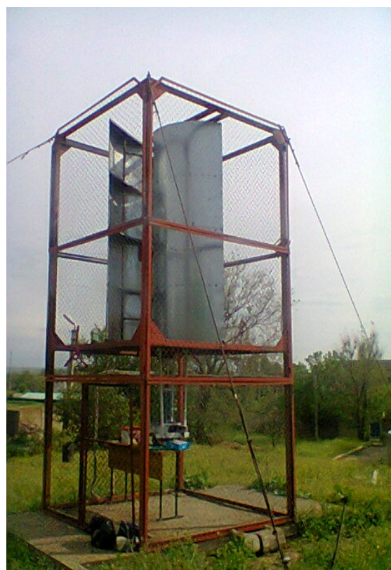
Рисунок 2. Экспериментальный образец вертикально – осевого ВЭУ
