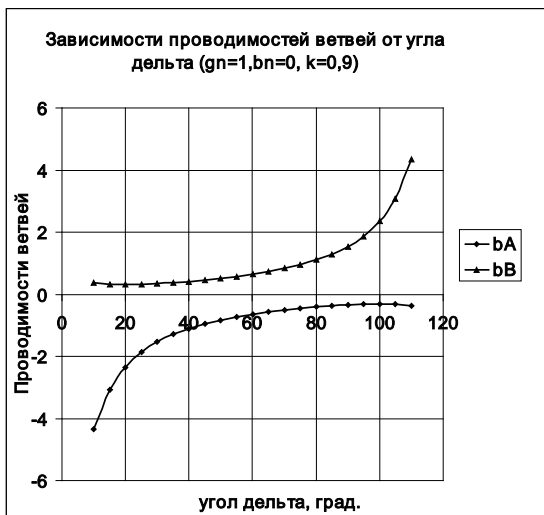
Рис.6. Зависимости проводимостей реактора и конденсатора от величины угла фазового сдвига \delta при активной нагрузке и коэффициенте преобразования k=0,9 .
