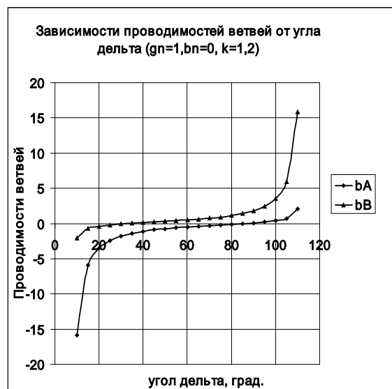
Рис.5. Зависимости проводимостей реактора и конденсатора от величины угла фазового сдвига \delta при активной нагрузке и коэффициенте преобразования k=1,2
