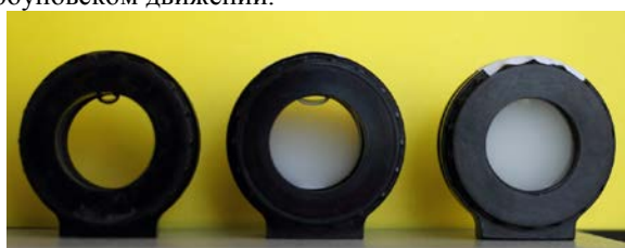
Рис. 1. Фотография хладоносителя (ХН) без добавок наночастиц (слева), нанохладоносителя (наноХН) хранящегося в статических условиях в течении 12 суток (посередине) и нанохладоносителя (наноХН) подвергавшегося механическому перемешиванию перед проведением исследований (справа) в ячейках с длиной оптического пути 4,05 мм
