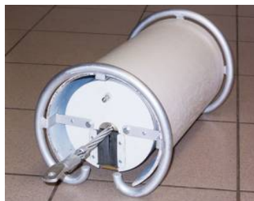
Рис. 1. Датчик контроля температуры проводов ВЛ РС
